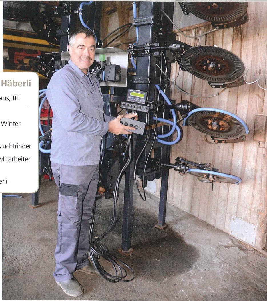
Martin Häberli mit den Bedienkästen für die Dosierung der Düngermenge und die hydraulische Geräte-Einstellung des FlisQr.
